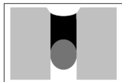
Углубленный шов с защищает герметик от воздействия механических нагрузок.
